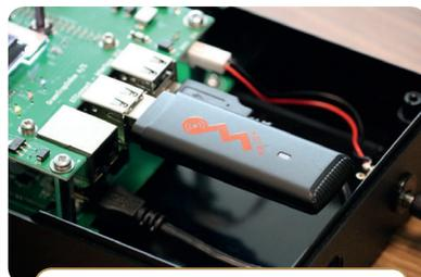
SOIT LA CLÉ MODEM POUR UNE CONNEXION VIA RÉSEAU 3G.
