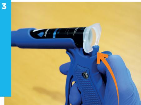
**...jusqu'à ce que la base de la cartouche soit bien positionnée sur le crochet supérieur de la gâchette (3).**
