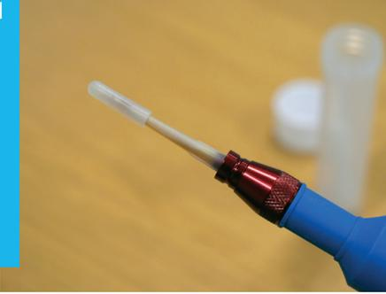
Mettez le capuchon (21) sur l'aiguille (19.3) et laissez-le pour éviter le séchage du gel à la sortie. Autre solution : retirer l'aiguille (19.3), la laver et reboucher l'adaptateur Safetylock (17) avec le bouchon de la cartouche de gel.
