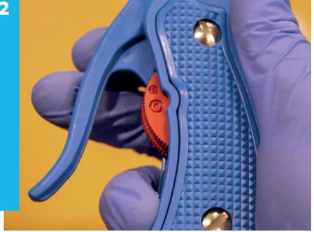
Régler la molette sur la position "0" pour éviter que la gâchette ne soit pressée par accident.
