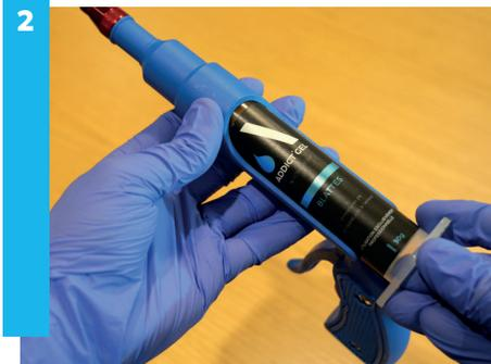
**Insérer la cartouche dans le compartiment du pistolet en l'enfonçant contre le piston (12)...**
