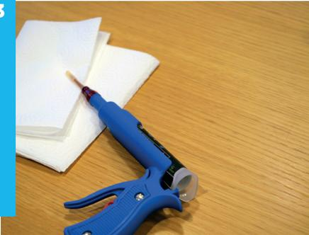
Laisser la cartouche de gel dans le compartiment du pistolet pour éviter que le gel laissé à l'intérieur du pistolet ne sèche, puis bloquer le piston et les autres pièces du pistolet.
