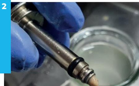
**Lavez à l'eau avec du détergent les pièces. Nettoyez ou remplacez les joints (14 et 16).**
