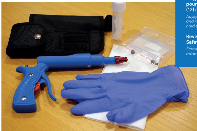
Le pistolet applicateur est conçu sur la théorie de la pression négative. Le produit est aspiré à travers le pistolet au lieu d'être poussé de manière traditionnelle par un piston, ce qui assure le dépôt d'une quantité précise de gel et évite les débordements.
