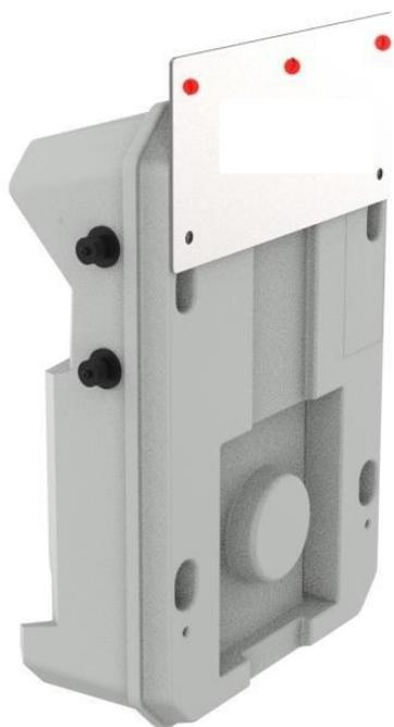
Visser l'ensemble sur le support de votre choix, à l'aide de vis adaptées (non fournies), dans les perçages en rouges ci-contre. Le diamètre des perçages est de 6,5 mm.
